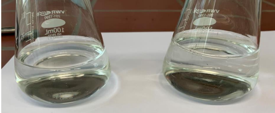
Image 3: comparaison des couleurs de lixiviation (g: blanco, d: E-24-038559/01, lixiviation à base d'eau de pluie)
