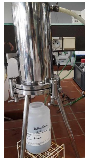
Image 2: Création d'une lixiviation (de gauche à droite : addition de médium d'extraction (bidest stérile), mélangeur aérien, configuration de la filtration)
